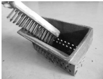
Figura 52 - Limpeza do cesto de queima
